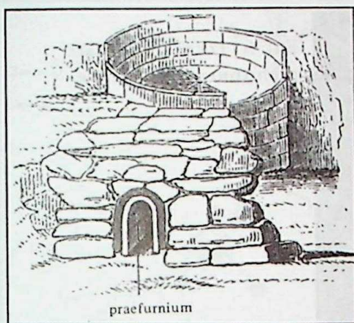
FIG. 3 - Disegno di una fornace romana
